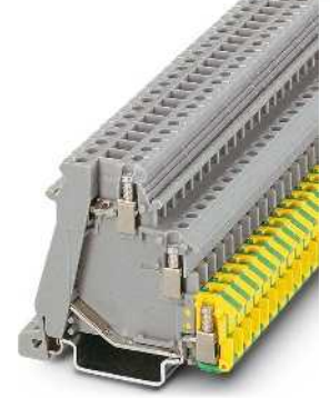
2.5 (4) mm 2 , 26 A, PE ayaklı üç iletkenli aktüatör klemensi
