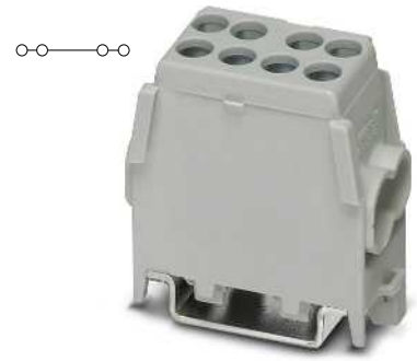
25 (25) mm 2 , 101 A, trunk hattı branş klemensi, 2x16 mm 2 çıkış
