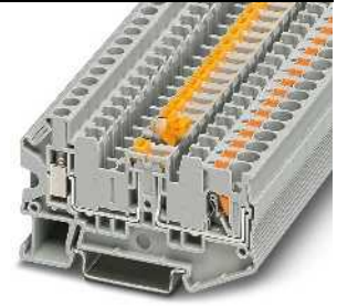
20 A, bıçaklı ayırma klemensi, 3 fonksiyon kanalı ve iki 4 mm test soketi
