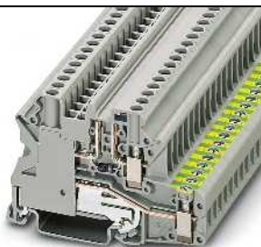
0.5 A, diyotlu klemens, 1N 4007 (1300 V/0.5 A), iletim yönü: soldan sağa doğru
