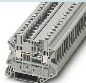
0.5 A, diyotlu klemens, 1N 4007 (1300 V/0.5 A)
