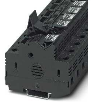
25 (25) mm 2 , 30 A, 1000 V, kollu sigortalı klemens, 10.3 x 38 mm mini sigortalar için
