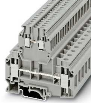
10 (16) mm 2 , 76 A, çift katlı klemens, üst katta 2 x 2,5 mm 2 geçme klemensler
