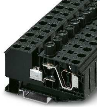
10 A, sigortalı klemens, 6,3 x 32 mm kartuş tipi sigortalar için
