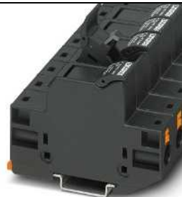
20 A, 1000 V, kollu sigortalı klemens, 10.3 x 38 mm mini sigortalar için
