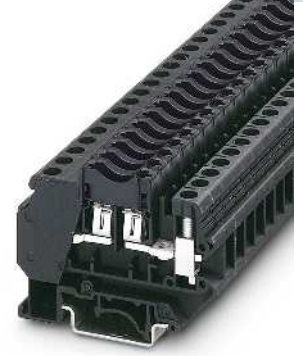
6 (10) mm 2 , 30 A, sigortalı klemens, C tipi yassı tip sigortalar için
