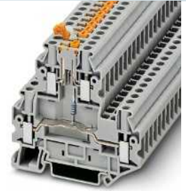
38 A, bıçaklı ayrılmalı çift katlı klemens, LED göstergeli
