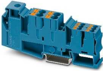
105 A, potansiyel toplayıcı klemens, 4 giriş 6 mm 2 , 6 giriş 2.5 mm 2
