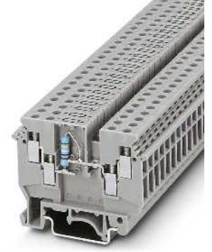
4 (6) mm 2 , geçiş klemensi, 4 bağlantılı, diferansiyel gerilim dirençli
