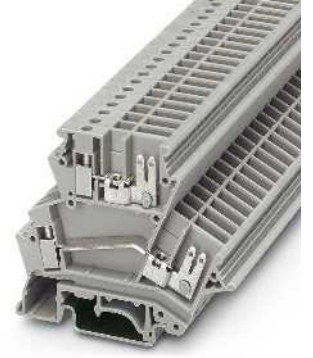
4 (4) mm 2 , 20 A, vida/slip-on bağlantılı iki katlı klemens
