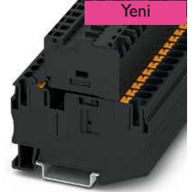
10 A, 6.3 x 32 mm kartuş sigortalar için kollu tip sigortalı klemens, 2 fonksiyon kanalı
