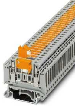
2,5 (4) mm², 16 A, bıçaklı ayırma klemensi, test soketi vidalı
