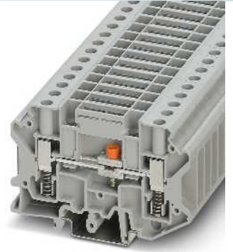
6 (10) mm 2 , 57 A, ölçme ayırma klemensi, anahtarlama köprüleri takılır, 2 bağlantı
