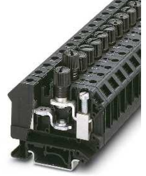
16 (16) mm 2 , 10 A, sigortalı klemens, 5 x 20 mm kartuş tipi sigortalar için
