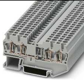
0.5 A, diyotlu klemens, 1N 4007 (1300 V/0.5 A), 4 bağlantı
