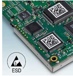
Kendinden yapışkanlı cihaz etiketleri, ESD uygulamaları için, termal transfer rulo yazıcılarıyla basılır EML-ESD... Sayfa 340
