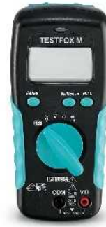
Dijital multimetre, temel işlevler
