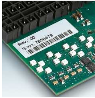
Yüksek sıcaklıklara yönelik kendinden yapışkanlı cihaz etiketleri, termal transfer rulo yazıcılarıyla basılır EML-HT... Sayfa 339
