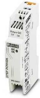
Güç kaynağı, 1 AC, 5 V DC, 2 A NEC Class 2
