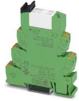
2-PDT röle modülü, 16.7 Hz giriş frekansı için, maks. 2 x 6 A
